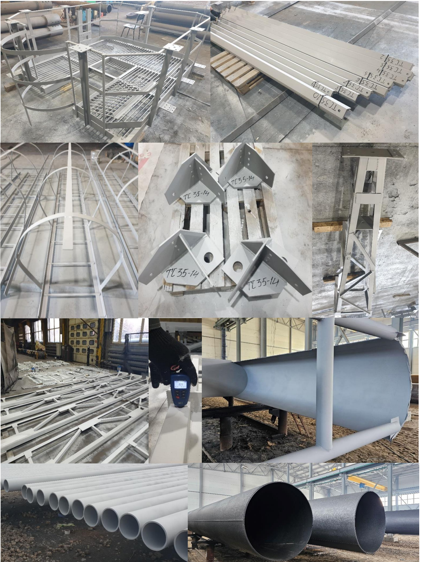
Рис.8 Нанесение различных защитных покрытий на поверхности (грунт, эмали, огнезащита и прочее).
