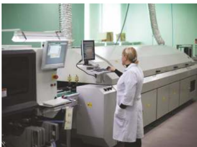
МОНТАЖ СВЕТОДИОДОВ НА ПЕЧАТНЫЕ ПЛАТЫ
