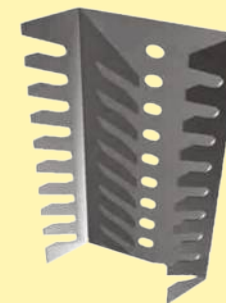
Держатель для ключей ДК-01 Устанавливается в любом месте на перфопанели рабочих мест. Служит для размещения гаечных ключей, различного рода инструмента, шпилек и т.п. Шаг перфорации крепления 50 мм. 9 пар вырезов под углом 45 градусов.
