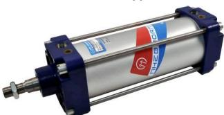
Цилиндры с гильзой из алюминиевой трубы изготавливаются Ø32...Ø320 мм по ТУ4151-001-16676426-99 с магнитом на поршне и являются аналогами цилиндров серии DNG (фирма FESTO), серии 40, 60 (фирма CAMOZZI) по габаритным и присоединительным размерам соответствуют международным стандартам ISO 6431 и VDMA 24562.
