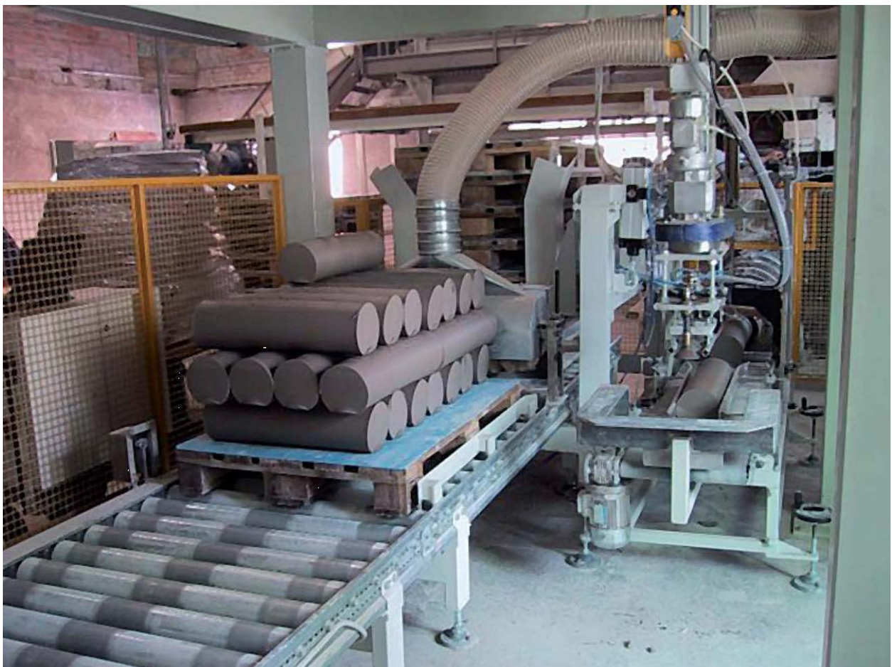
Укладчик разрезанных глиняных прутков на поддоны
