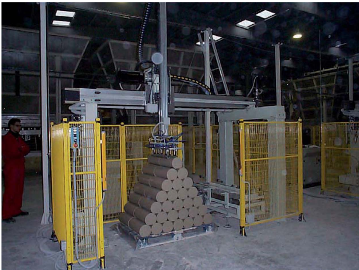
Укладчик разрезанных глиняных прутков на поддон
