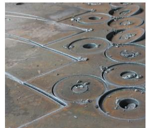
Режем любые детали из металла толщиной - 2-20 мм (плазменная резка) и толщиной - 20-150 мм (газовая резка).
