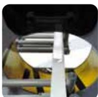
Одновременная работа с двумя рулонами пленки
