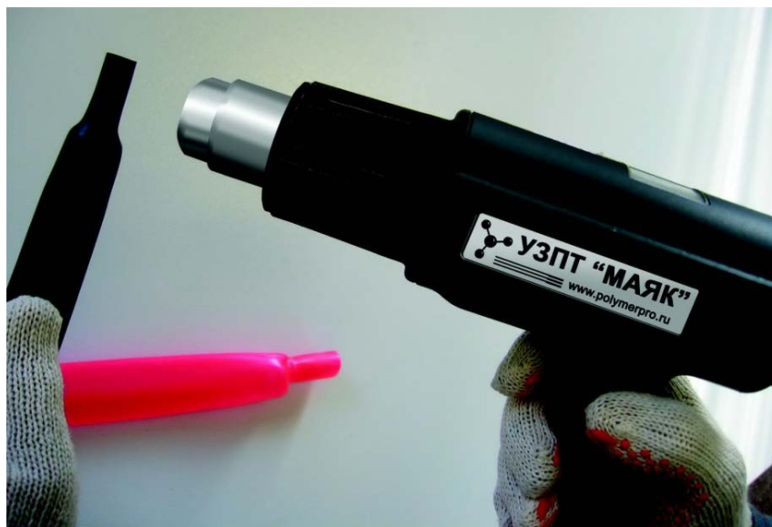
Рисунок 1 – Процесс термоусадки ТТП
