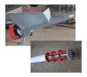
**Шнек** перемещает высушенный продукт из бункера разгрузки в норию. Усиленная у основания непрерывная цельнотянутая спираль обеспечивает долговечность шнека при эксплуатации, а наличие реверсного режима работы, позволяет экономить на электроэнергии.
