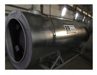
**Топочный блок** обеспечивает равномерный косвенный нагрев агента сушки. Топочный блок с теплообменником исключает возможность попадания в теплоноситель продуктов горения топлива и воспламененных частиц. Это позволяет применять более широкий спектр видов топлива. Нагретый воздух не влияет на качество высушиваемых агрокультур.
