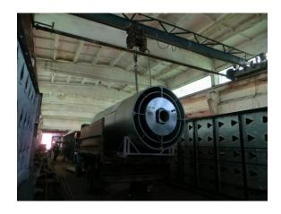
Сушилки поставляются укрупненными блоками заводской сборки. В смонтированном состоянии сушилка полностью герметична, все ее поверхности, имеющие контакт с теплоносителем, покрыты теплоизоляцией, облицованы оцинкованным металлопрокатом.
