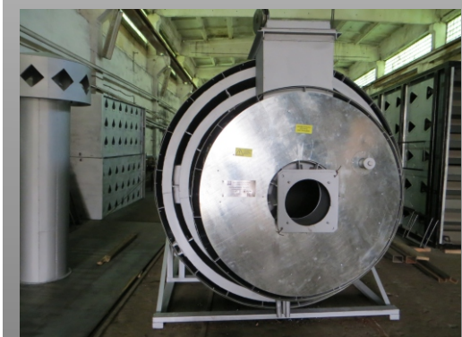
Топочный блок RIR косвенного нагрева ТБ-1,6ТО
