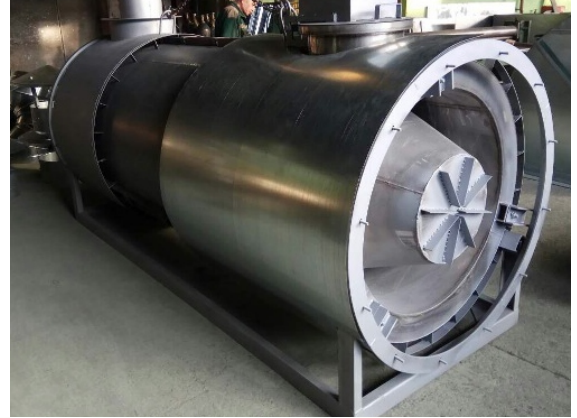
Изготовление переходника к сушилке М-819
