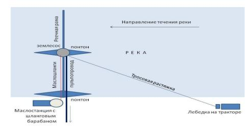
Специально для данного вида работ на реке с сильным течением Центром по сапропелю разработана технология ведения добычи песчано-гравийной смеси с применением стационарно-динамического извлечения материала. Технология позволяет отрабатывать донный слой ПГС мощностью до 18 м и развивать производительность землесоса по твердому до 150 м³/ч. Направление отработки пласта – по течению реки.
