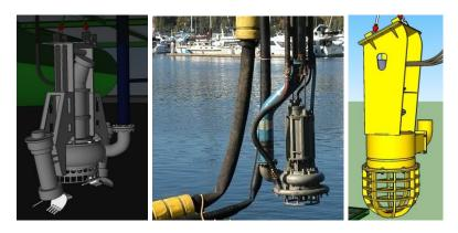
Центр по сапропелю разработал для землесосов плавучую стационарно-динамическую понтонную платформу способную нести комплект добычного оборудования и пульпопровод при сильном речном течении, в местах, где невозможно применение земснарядов, т.е. якорение или удержание земснаряда сваями практически невозможно или сопряжено с определенным риском.
