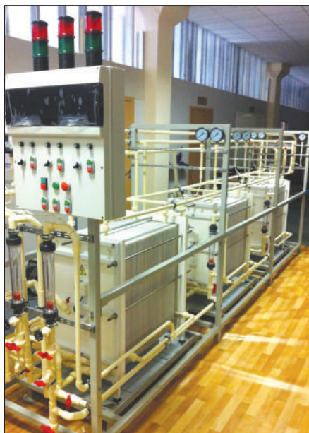
Фото 1. Промышленная трехпакетная электродиализная установка
