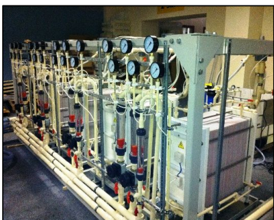
Установка с 4-мя последовательно подключенными аппаратами
