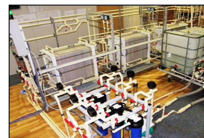
Установка с 3-мя последовательно подключенными аппаратами
