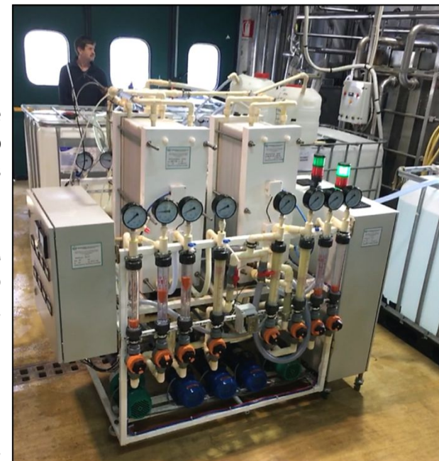
Мобильный малотоннажный электродиализный комплекс МТЛТ по Технологии ED-EDBM.
