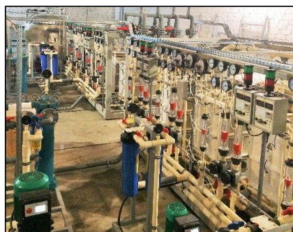
Комплекс с 8-ю аппаратами, установленными в одну ступень
