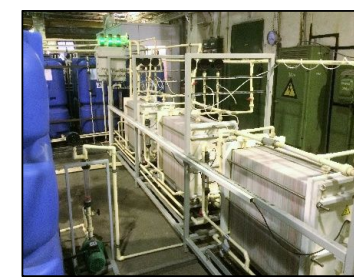
Установка с 3-мя последовательно подключенными аппаратами
