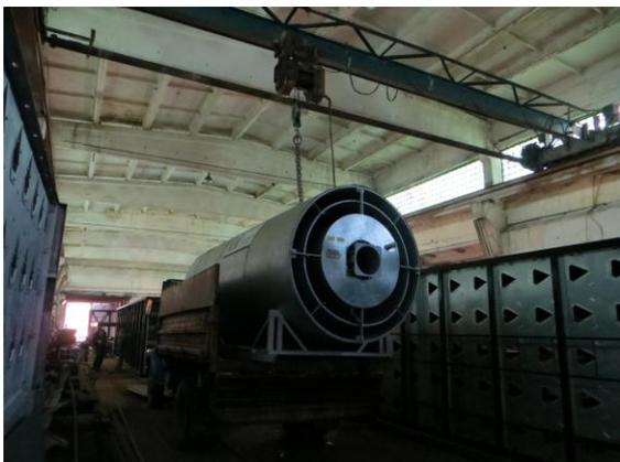
Сушилки поставляются укрупненными блоками заводской сборки. В смонтированном состоянии сушилка полностью герметична, все ее поверхности, имеющие контакт с теплоносителем, покрыты теплоизоляцией, облицованы оцинкованным металлопрокатом.
