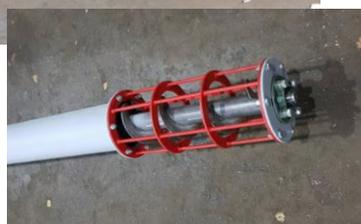
**Шнек** перемещает высушенный продукт из бункера разгрузки в норию. Усиленная у основания непрерывная цельнотянутая спираль обеспечивает долговечность шнека при эксплуатации, а наличие реверсного режима работы, позволяет экономить на электроэнергии.
