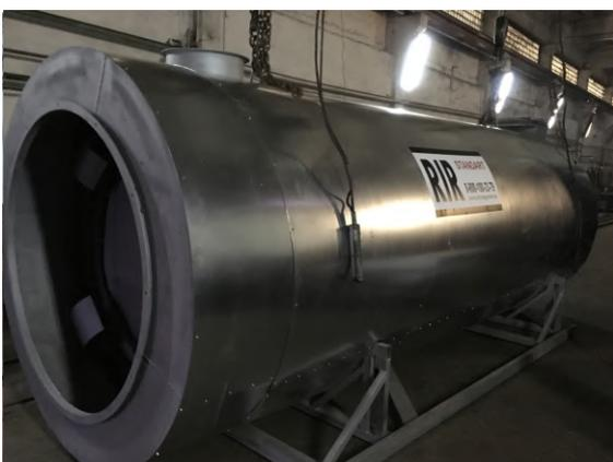
**Топочный блок** обеспечивает равномерный косвенный нагрев агента сушки. Топочный блок с теплообменником исключает возможность попадания в теплоноситель продуктов горения топлива и воспламененных частиц. Это позволяет применять более широкий спектр видов топлива. Нагретый воздух не влияет на качество высушиваемых агрокультур.
