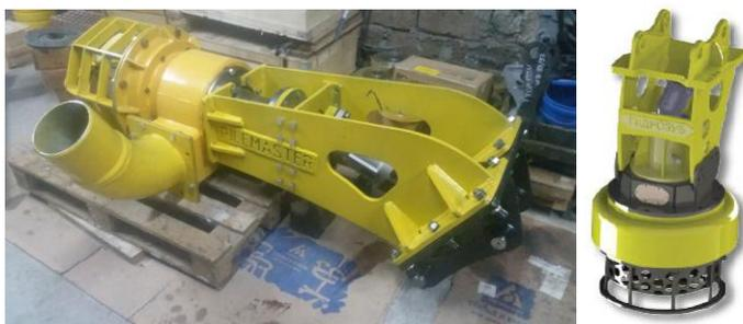
Для повышения коэффициента породозабора землесосом используются установленные на нем активаторы. а при разработке уплотненных песков с глиной землесосы комплектуются гидравлическим рыхлителем.
