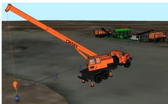
Первые образцы оборудования подготовлены для заказчиков из России и Азербайджана где их использование запроектировано на реках с большой скоростью течения и малой мощностью продуктивного слоя. Добычное оборудование – землесос навешивается на стрелу пневмоколесного крана с противовесом, подача гидросмеси на промывочно-сортировочный узел осуществляется мягким плоско-резиновым пульпопроводом  $Dy=159-220$  мм.
