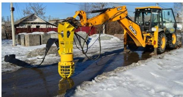
Испытания агрегатов проводились в условиях месторождения с характеристиками: грансостав ПГС – песка общего – 90%, галька до 50 мм – 5%, глина плотная – 5%. Мощность разрабатываемого слоя – 1.5-6 м. В процессе работ энергозатраты на 1 м<sup>3</sup> песка составили 1.32 кВт. Количество обслуживающего персонала – 2 чел. Фактическая производительность по промытому песку в смену составила 648 м<sup>3</sup>.
