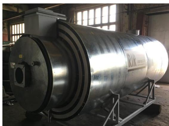
**Топочные блоки с косвенным нагревом** исключают возможность попадания в теплоноситель продуктов горения топлива и воспламененных частиц, что позволяет применять более широкий спектр видов топлива. Нагретый воздух экологически безопасен, не влияет на качество высушиваемых агрокультур. Топочные блоки с косвенным нагревом теплоносителя незаменимы при сушке зерновых, зернобобовых, масличных и крупяных культур продовольственного и семенного назначения.
