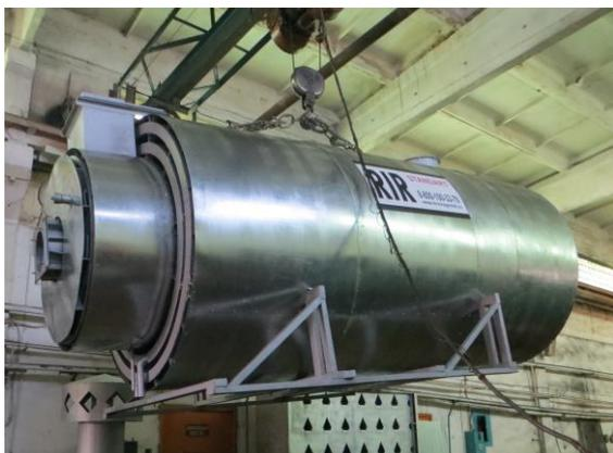
Топочные блоки RIR поставляются в собранном виде. Транспортировка осуществляется любым видом транспорта, для погрузки и разгрузки предусмотрены грузовые петли. Для ввода в эксплуатацию необходимо выполнить только подвод электроэнергии и топлива к горелочному устройству. По запросу покупателя могут быть выполнены пуско-наладочные работы и сервисное обслуживание оборудования RIR.
