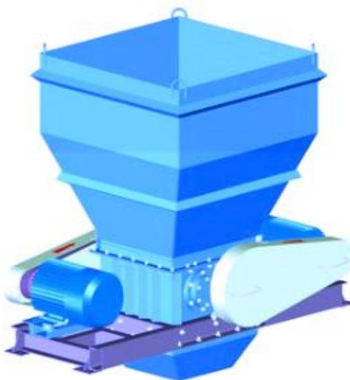
Измельчители роторно-дисковые, серии «ИД» предназначены для измельчения материалов с влажностью до 40%: удобрения, сухая глина, влажный торф, гипс. Для использования измельчителя непосредственно по торфу влажность сырья может достигать до 60%.
