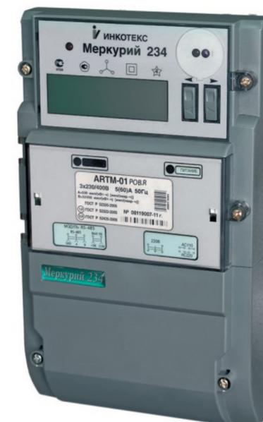
Технология **PLC-II** предназначена для создания сетей дистанционного сбора данных и управления микропроцессорными счётчиками электроэнергии типов «Меркурий-203», «Меркурий-234».
