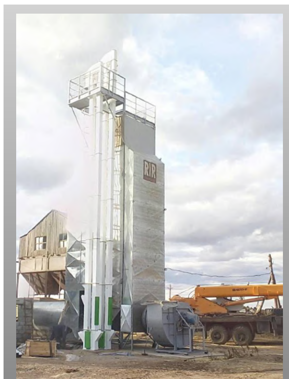
RIR-15C техническая производительность 15т/час
