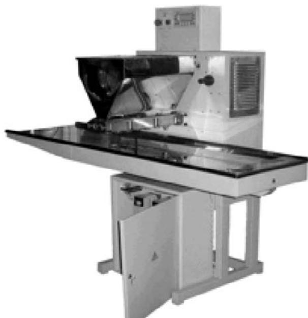
Предназначена для формования заготовок кондитерских изделий путем продавливания теста через насадки различной конфигурации. Состоит из станины, дозатора, транспортера, механизма подъема транспортера и шкафа управления. Узлы и агрегаты, непосредственно контактирующие с продуктом, выполнены из нержавеющей стали, разрешенной для применения в пищевой промышленности.
