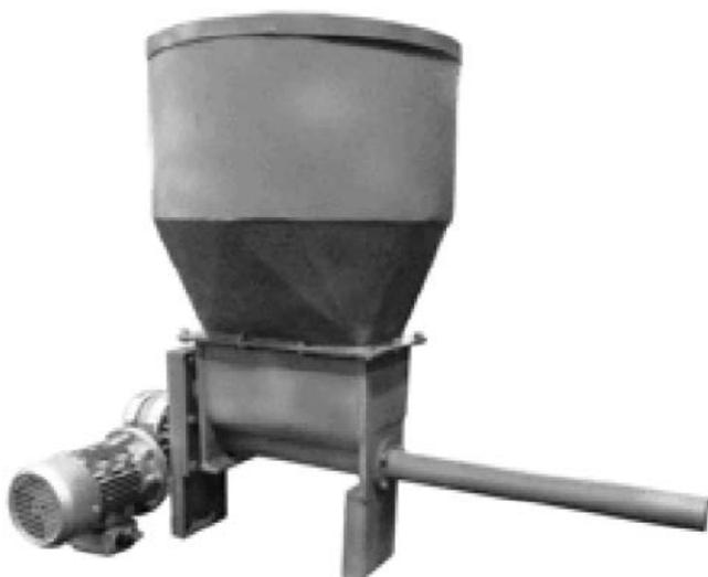
Предназначен для подачи порошковых материалов в технологическое оборудование. Питатель снабжен устройством, исключающим зависания дозируемого материала и образования свода, что позволяет обеспечить гарантированную непрерывную подачу порошковых материалов в зону обработки. Питатель состоит из корпуса, в котором расположен подающий шнек, мешалка – ворошитель, редуктор ворошителя и мотор-редуктор привода шнека. В верхней части корпуса крепится бункер для загрузки материала.
