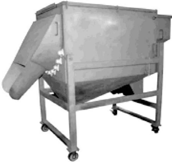
Применяется в цехах по переработке плодоовощной продукции. Состоит из рамы, моечной ванны, щеточных валов, трубопроводов, системы управления. Конструкция моечной ванны имеет сливные горловины: одна для слива отстоявшейся воды, которая может быть использована повторно, вторая для слива отстоявшейся грязи.
