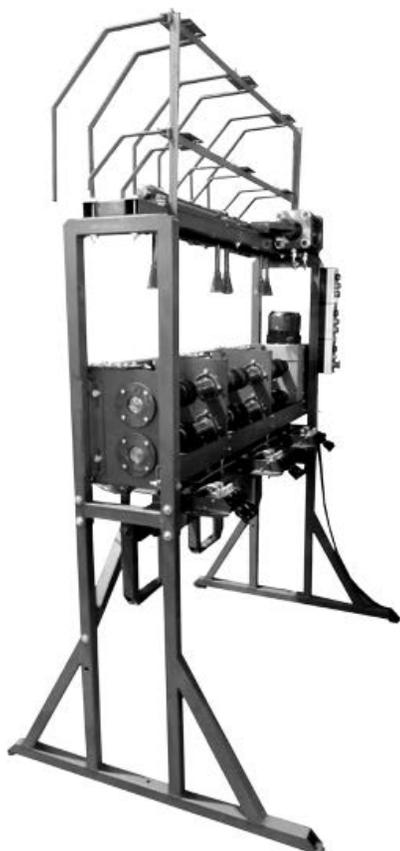
Предназначена для получения прутков припоя методом непрерывного вытягивания вверх литевых заготовок из медного расплава и рубки их на мерные обрезки.
