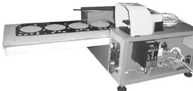
Предназначено для транспортирования металлической уплотнительной прокладки в струйный маркировочный принтер. Состоит из основания, на котором смонтированы все механизмы устройства для нанесения маркировки, подвижного стола с покрытием белого цвета, привода, электрошкафа оборудования. Скорость подачи в зону маркировки задается регулятором. Упоры, предусмотренные в конструкции, дают возможность выполнять печать на разных видах заготовках.
