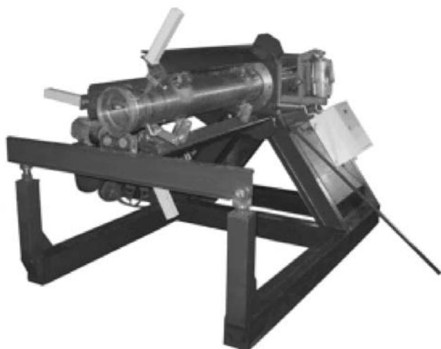
Приводные, консольные, разматыватели предназначены для установки и размотки рулонов тонколистового металлопроката (черного, оцинкованного, оцинкованного с лакокрасочным покрытием, пр.). Могут использоваться как в качестве отдельной единицы оборудования, для размотки рулонов, так и в составе технологических линий, использующих в качестве заготовки рулонный металлопрокат (линии профилирования, линии поперечной, продольной, продольно-поперечной резки).
