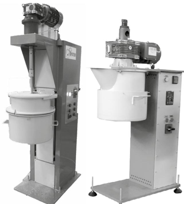
Предназначено для приготовления гранул из порошка со связкой, влажностью 4-6%, методом механической протирки через сетку с ячейками, необходимыми по технологии производства. Сито имеет загрузочное устройство, через которое подготовленный порошок постепенно засыпают в рабочую камеру. Частота вращения протира и регулирование засыпаемой дозы позволяет подобрать технологию получения необходимой фракции. Средняя производительность 20кг/ч, зависит от свойств порошка.
