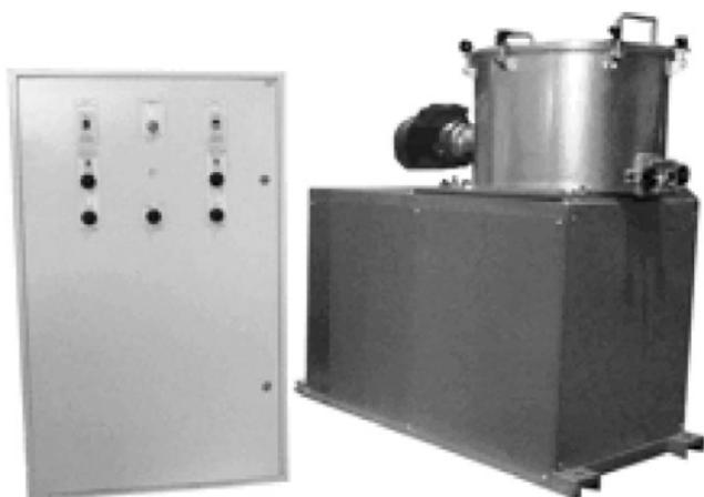
Предназначен для проведения комбинированного процесса сухого смешивания и мокрой грануляции в одностадийном процессе производства керамических, твердосплавных, строительных, фармацевтических, пищевых и других материалов. Смеситель - гранулятор состоит из рамы, на которой расположен привод лопастной мешалки, смесительная камера и привод гранулирующей головки.
