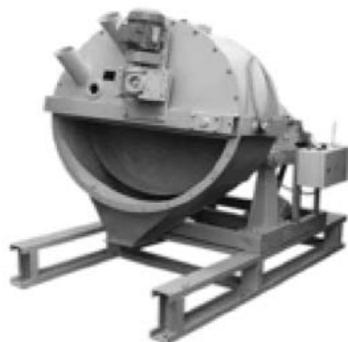
Предназначены для получения гранул из порошковых материалов методом окатывания с использованием жидкой связки. Состоят из станины, на которой закреплена поворотная рама, круглая тарель с приводом. Поворот рамы осуществляется от отдельного привода. Грануляторы снабжены устройством для подачи связки.
