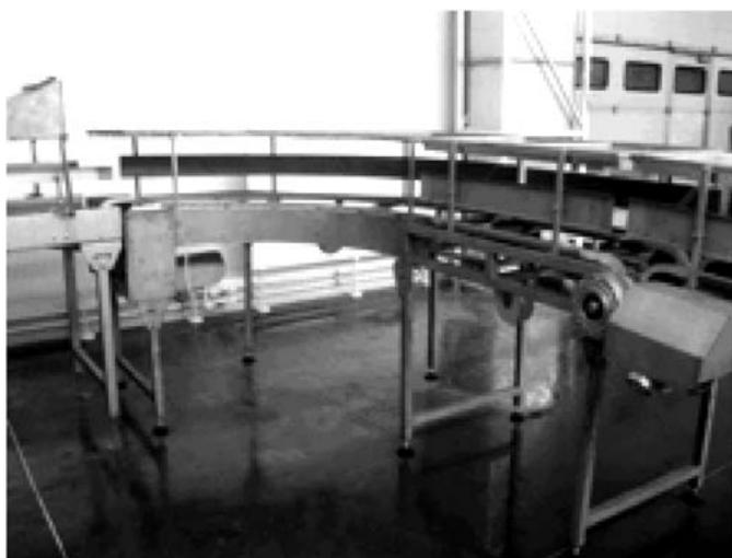
Предназначен для транспортирования с изменением направления движения пищевых и любых других продуктов в технологической таре. Состоит из рамы, на которой установлены привод, натяжной и приводной узлы, цепи, опоры. Мотор редуктора напрямую подсоединен к приводному узлу, через который приводится в движение цепь. Материалы транспортеры: нержавеющая сталь, разрешенная для применения в пищевой промышленности.
