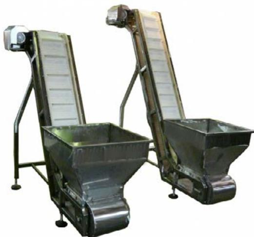
Предназначены для транспортирования различных продуктов в пищевой промышленности. Состоят из рамы основания, модульной ленты с перегородками, механизма привода движения модульной ленты, механизма натяжения модульной ленты, приемного бункера, электрошкафа с пультом управления.
