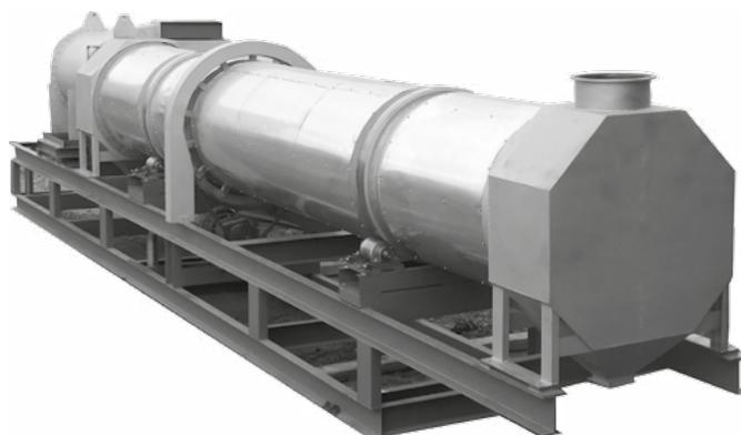
Предназначен для сушки сыпучих материалов в различных отраслях промышленности: химической, строительной, лакокрасочной, в порошковой металлургии и т.д.
