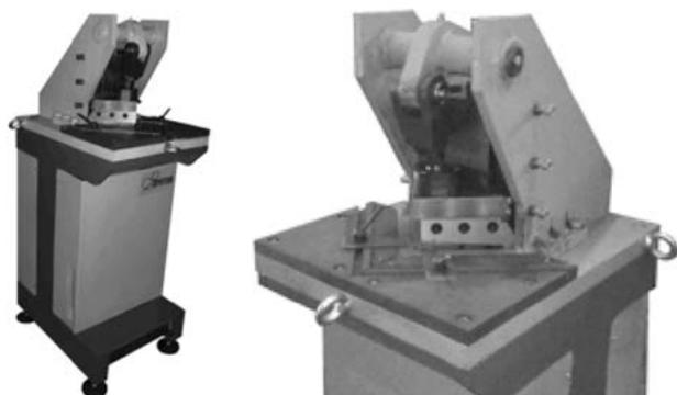
Предназначены для вырубki угловых сегментов в плоских деталях и разделки полок уголков под сварку. Состоят из основания, в направляющих которого имеется ползун. Усилие на ползун передается от пневмоцилиндра. Размер вырубаемой полки устанавливается по упорам, перемещающимся по линейке с последующей фиксацией
