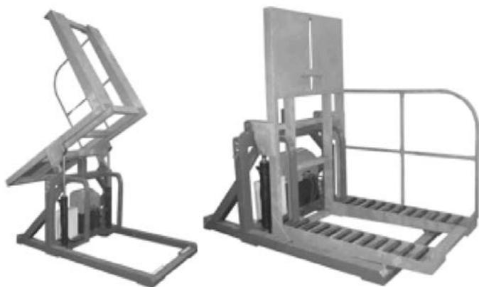
Предназначен для разгрузки контейнеров с макулатурой или другими материалами. Состоит из неподвижной рамы, на которой размещаются гидростанция, гидроцилиндры, пульт управления и опоры подвижной рамы. Подвижная рама оснащена рольгангом, предназначенным для облегчения перемещения контейнеров. Гидропривод обеспечивает плавность и бесшумность работы кантователя.
