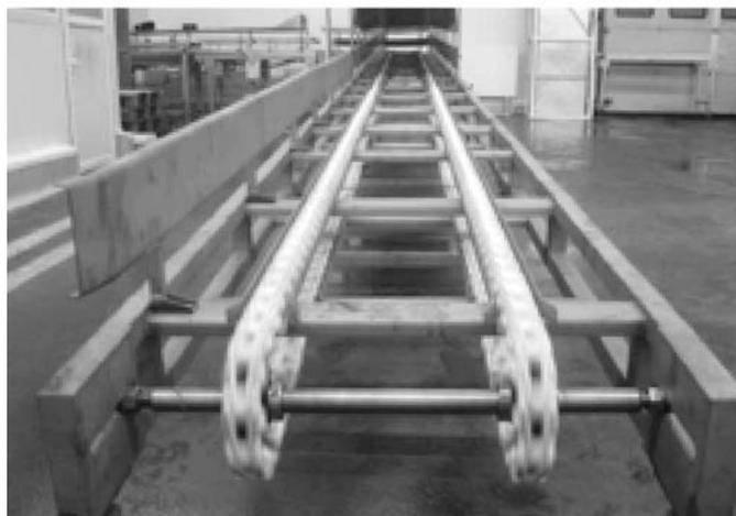
Предназначен для транспортирования различных продуктов в технологической таре. Состоит из рамы, на которой установлены привод, натяжной и приводной узлы, цепи, опоры. Привод состоит из мотор редуктора, напрямую подсоединенного к приводному узлу, через который приводится в движение цепь. Материалы транспортера - нержавеющая сталь.
