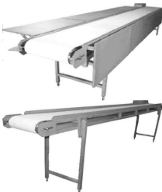
Предназначены для транспортирования различных продуктов в пищевой промышленности к местам их последующей переработки, фасовки и хранения. Состоят из рамы, на которой установлены привод, натяжной и приводной барабаны, лента, опоры. Мотор-редуктор напрямую подсоединен к приводному барабану, через который приводится в движение лента. Материалы транспортеров: нержавеющая сталь, разрешенная для применения в пищевой промышленности.
