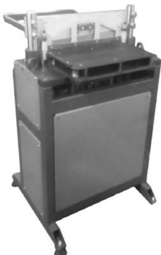
Предназначены для отрезки по упору или разметке полос металлических и неметаллических листовых заготовок.
