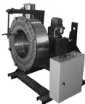
Частота вращения тарели регулируется с помощью частотного преобразователя. Тарель изготавливается в двух исполнениях, из углеродистой и нержавеющей сталей. Тарель гранулятора ГТ-1,5 снабжена устройством для очистки боковых стенок и дна от налипшего материала. Возможно использование, как в периодическом режиме, так и в непрерывном.
