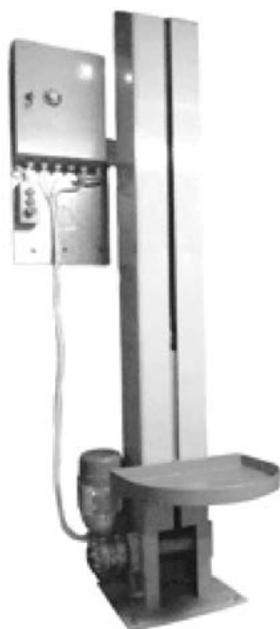
Предназначен для транспортирования различных продуктов в пищевой промышленности. При работе подъемника не допускается находиться в зоне движения стола.
