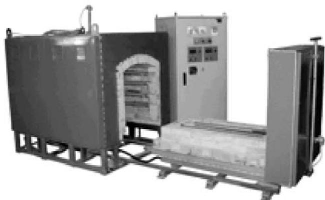
Предназначена для обжига изделий из керамики и других материалов. Состоит из станины, кожуха, камеры нагрева, футеровки огнеупорными и теплоизоляционными материалами, электрошкафа. Управление с отдельного пульта, оснащенного системой микропроцессорного регулирования температуры в печи.
