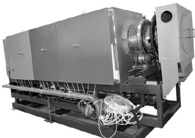
Предназначены для обжига порошковых материалов. Состоят из футерованной нагревательной камеры, внутри которой вращается труба, обогреваемая силиконовыми нагревателями, загрузочного устройства и пульта управления. Труба опирается на четыре опорных ролика и цепную передачу.
