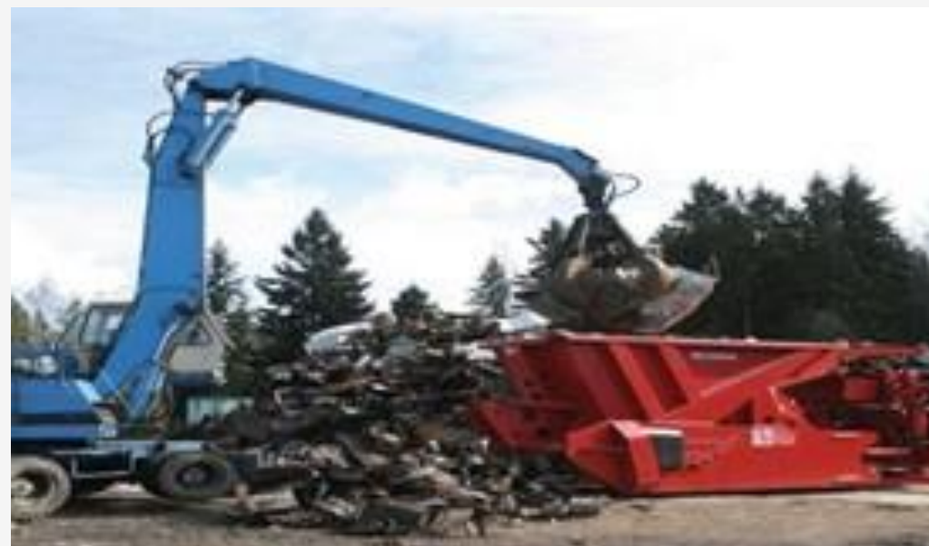
Пресс-ножницы для металлолома
